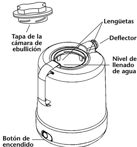
7. Seque toda el agua del exterior y la base de la cámara de ebullición, además del área alrededor de la conexión eléctrica.
