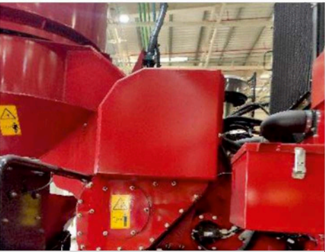
Cubierta del volante del picador Protección adicional para el volante del picador
