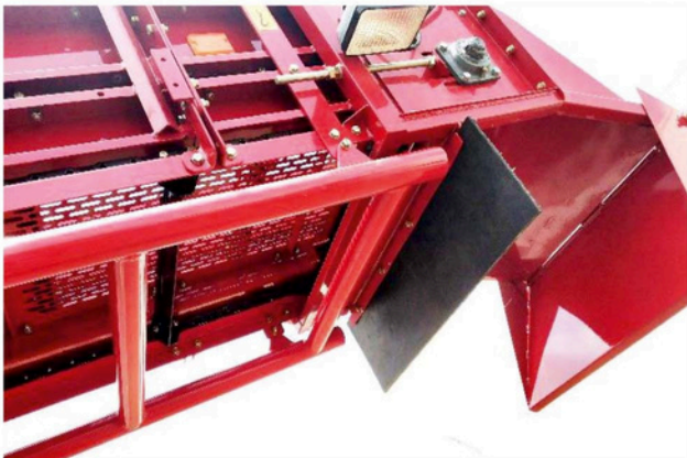
Aleta de goma del elevador Evita que los lingotes caigan al suelo durante el llenado
