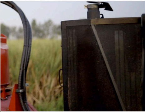
Mejora en el sellado de la jaula El motor queda protegido contra la entrada de residuos, mejorando la productividad y la seguridad
