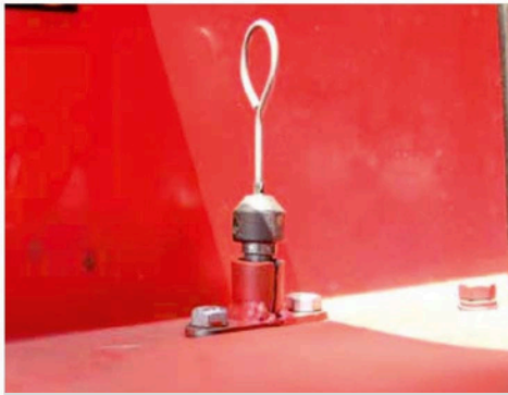
Varilla de aceite reubicada Facilidad de acceso y evita la apertura frecuente de la jaula de pájaros
