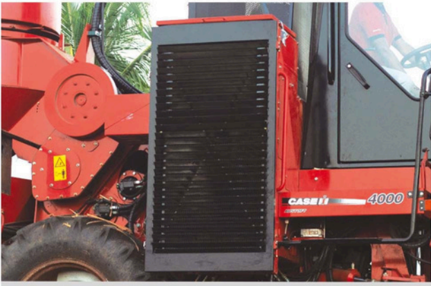
Radiateur plus grand Efficacité de refroidissement accrue.
