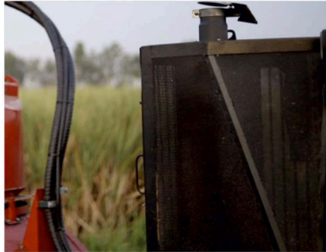
Amélioration de l'étanchéité de la cage Le moteur est protégé contre l'entrée de déchets, améliorant la productivité et la sécurité.
