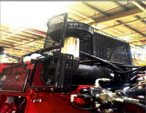
Protecteur du pré-nettoyeur Sécurité accrue contre l'impact de la canne.
