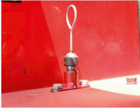
Jauge d'huile repositionnée Facilité de test et ouverture fréquente de la cage à oiseaux évitée
