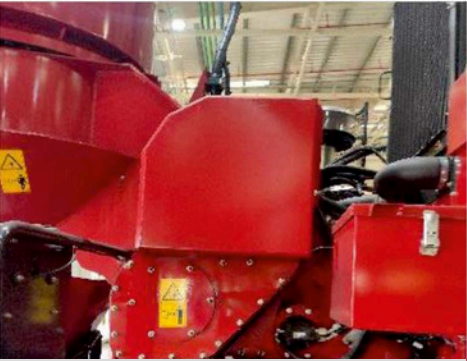
Couvercle du volant du broyeur Protection supplémentaire pour les lames du broyeur
