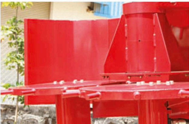
Disc-O-Gather Topper* Garantit une excellente élimination des cosses, ce qui réduit la quantité de résidus entrant dans la machine et la consommation de carburant.
