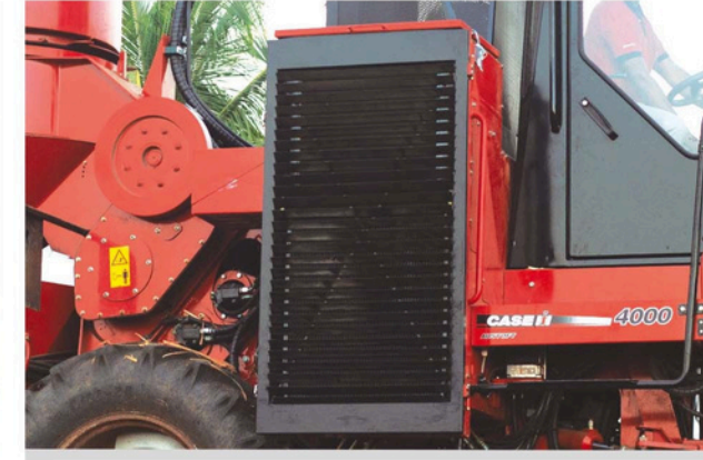
หมอน้ำขนาดใหญ่ขึ้น เพิ่มประสิทธิภาพการระบายความร้อน
