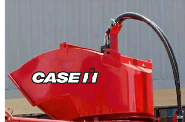
ชุดดัดอ้อยแบบทวนสูง เพิ่มความทนทานในการสัดสิ่งปนเปื้อนในอ้อย
