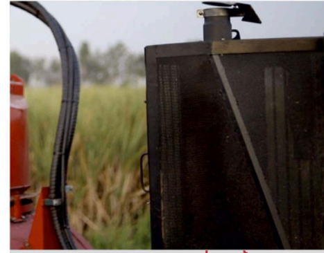
การปิดผนึกห้องเครื่องดีขึ้น ช่วยป้องกันเศษวัสดุเข้า ลดปัญหา และเพิ่มความปลอดภัย
