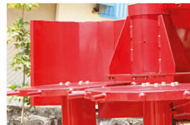
ดิสก์สำหรับกำจัดใบและเปลือกอ้อย รับภาระการกำจัดใบอ้อยได้อย่างดีเยี่ยม ลดปริมาณเศษวัสดุ ที่เข้าสู่เครื่องจักร และช่วยลดการใช้ น้ำมันเชื้อเพลิง
