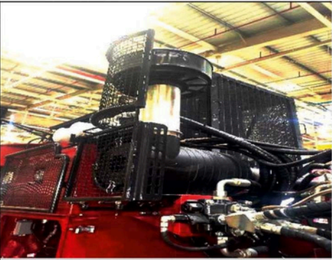
แผ่นป้องกันฟรินคลินเนอร์ ช่วยเพิ่มความปลอดภัยจากแรงกระแทกของอ้อย
