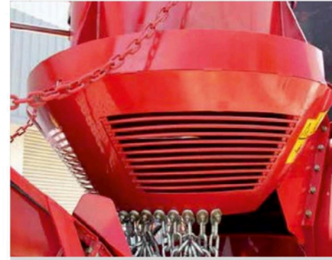
ระบบทำความสะอาด Turbo Air Drag ประสิทธิภาพการกำจัดสิ่งสกปรกดีขึ้น
