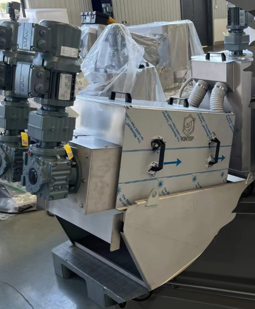
Prensa deshidratadora de lodos activados Mars Wrigley, México
