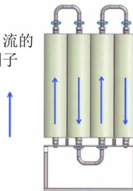
注意: 进口流可以来自ST模块的任何一端, 但膜元件必须切合流动方向安装
