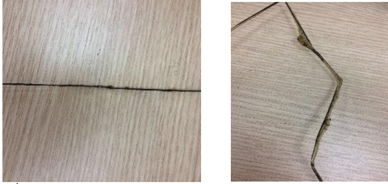
Şekil 4. İncelen ve kırılan filament (sağda), kalın ve baskısı olmayan filament (solda)
