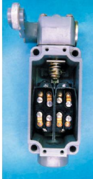
ပုံ ၁၁.၃ contact များအား မြင်တွေ့နိုင်စေရန် အဖုံးဖွင့်ထားသော limit switch
