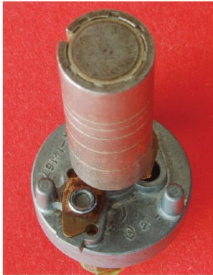
ပုံ ၄.၂၂ dashpot timer တစ်လုံးအတွက် time delay ရရှိစေရန် orifice တို့၏ အကျယ်အား set လုပ်ပေးနိုင်ပါသည်။
