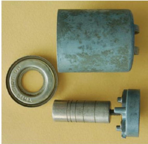
ပုံ ၄.၂၀ dashpot timer တစ်လုံး ဖြစ်ပြီး ယင်းတွင် အဓိကအားဖြင့် piston၊ shaft နှင့် container တို့ပါရှိပါသည်။
