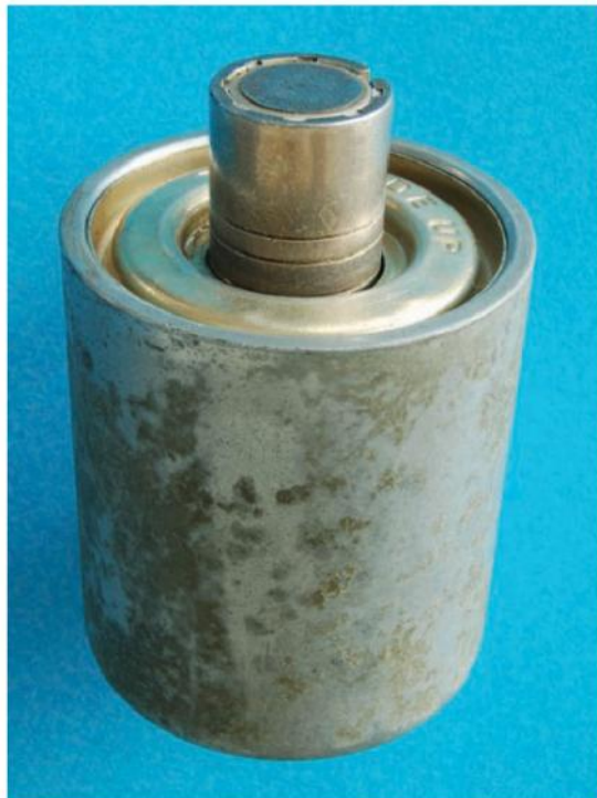
ပုံ ၄.၂၇ shaft အပေါ်ရှိ line သည် အလိုရှိသော လျှပ်စီးပမာဏ ကို ရည်ညွှန်းကာ dashpot container ၏ ထိပ်ဖက်နှင့် တညီတည်းဖြစ်စေရန် set လုပ်ထားခြင်းဖြစ်ပါသည်။
