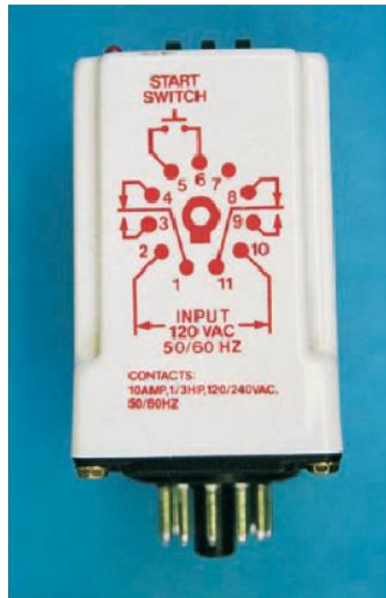
ပုံ ၇.၂၀ Dayton timer တစ်လုံး၏ pin connection diagram
