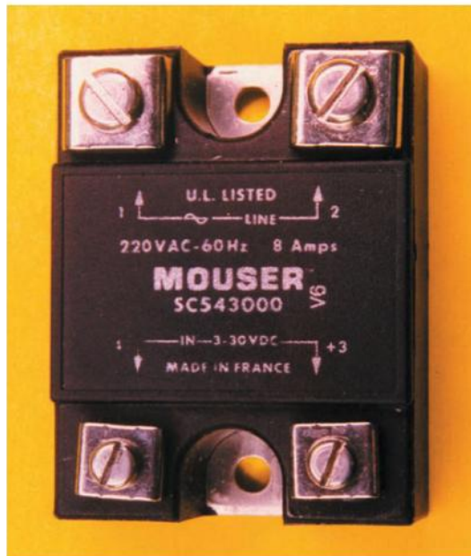
ပုံ ၅.၂၃ ၂၄၀ ဗို့အခြေအနေတွင် ၈ အမ်ပီယာအထိ control လုပ်နိုင်သော solid-state relay
