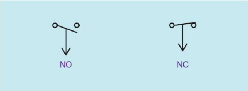
ပုံ ၇.၂ off-delay normally open နှင့် normally closed ဖြစ်နေသော contact များ
