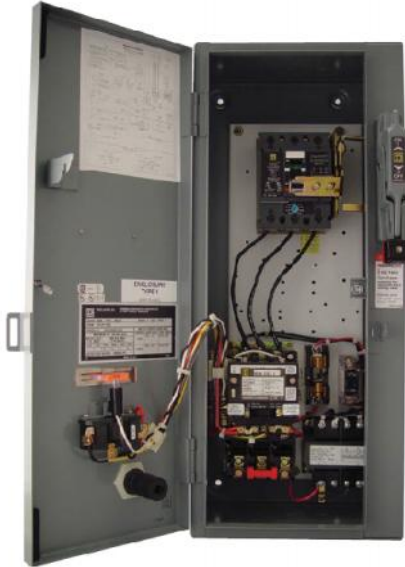
ပုံ ၁.၅ circuit breaker၊ disconnect switch၊ starter နှင့် control transformer တို့ စုစည်းပါဝင်သော combination motor starter
