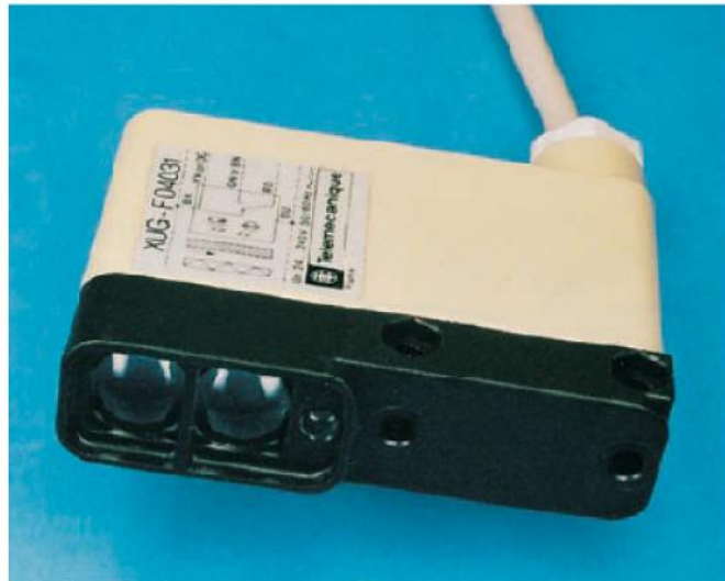
ပုံ ၁၇.၁၇ transmitter နှင့် receiver နှစ်ခုစလုံးပါရှိသော photodetector
