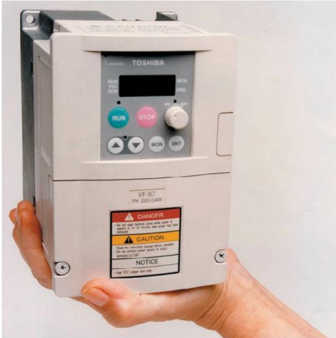
ပုံ ၄၆.၁၈ program ထည့်သွင်းအသုံးပြုနိုင်သော variable frequency drive တစ်လုံး။
