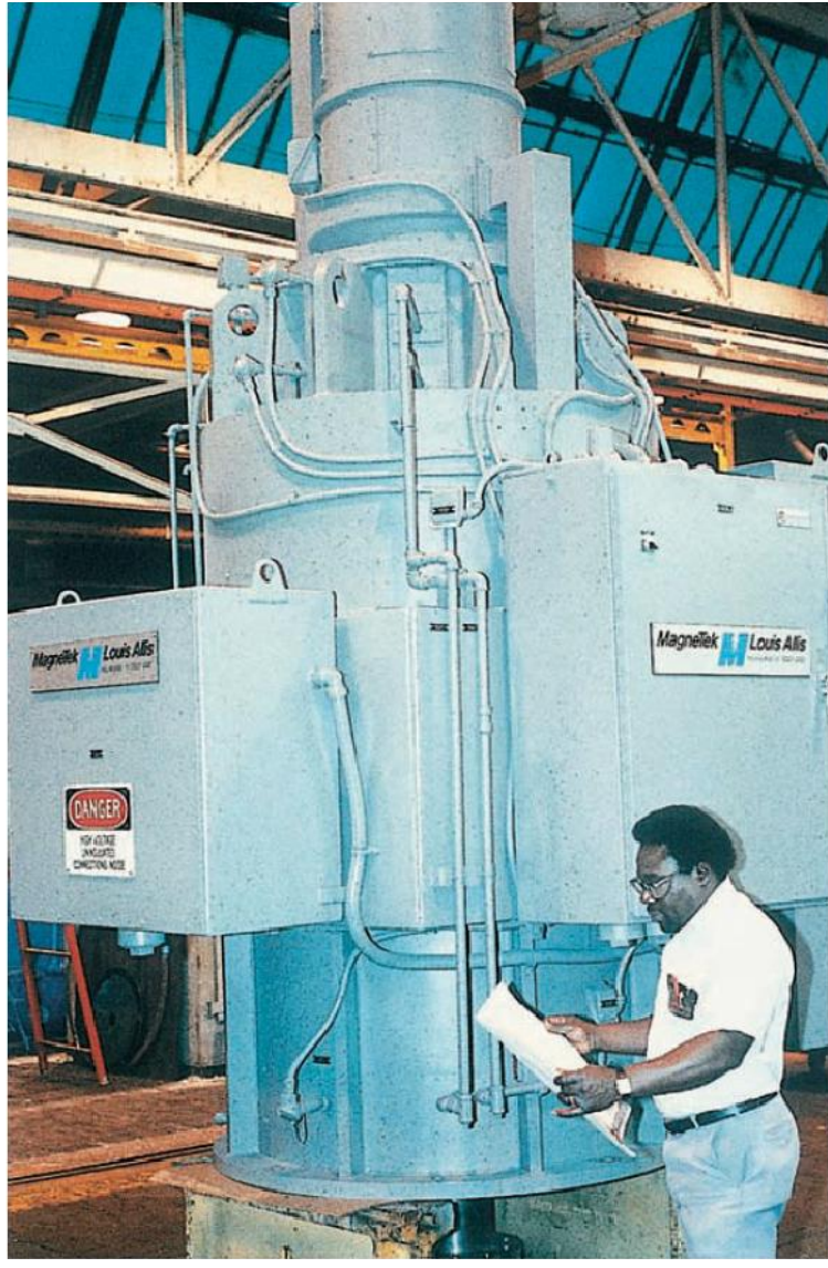
ပုံ ၄၅.၁၂ မြင်းကောင်ရေ ၂၅၀၀ ရှိ synchronous motor တစ်လုံးဖြင့် ရေလည်ပတ်သောပန့်အား မောင်းနှင်ပုံ
