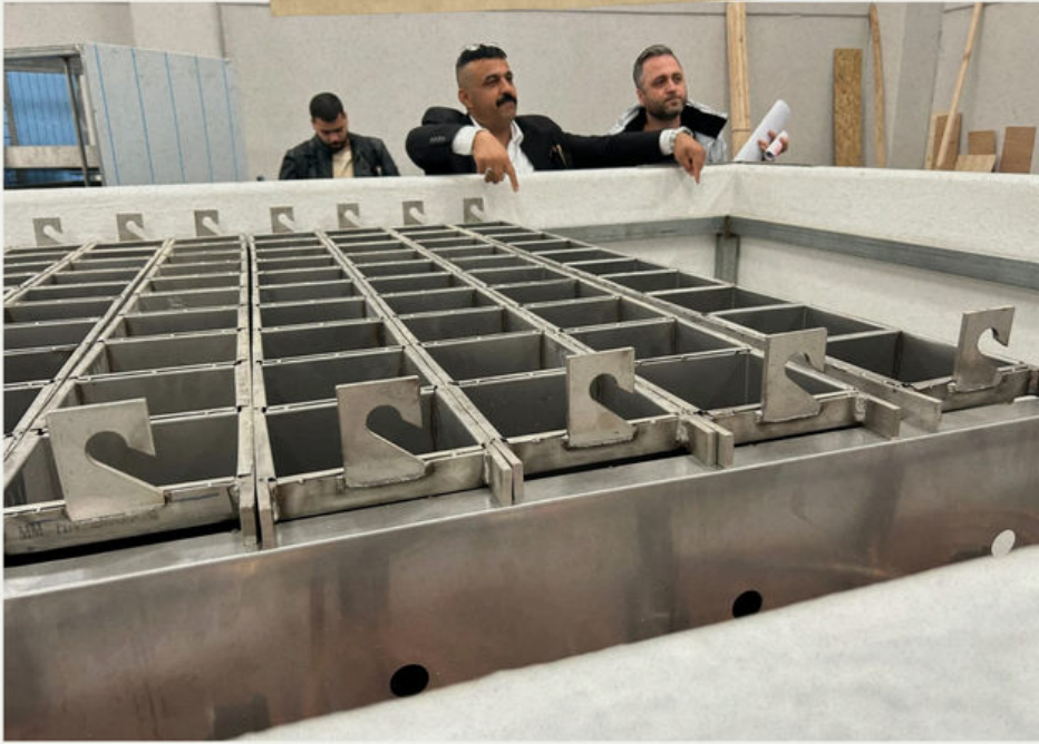
Birleştirilmiş Buz Kalıpları
