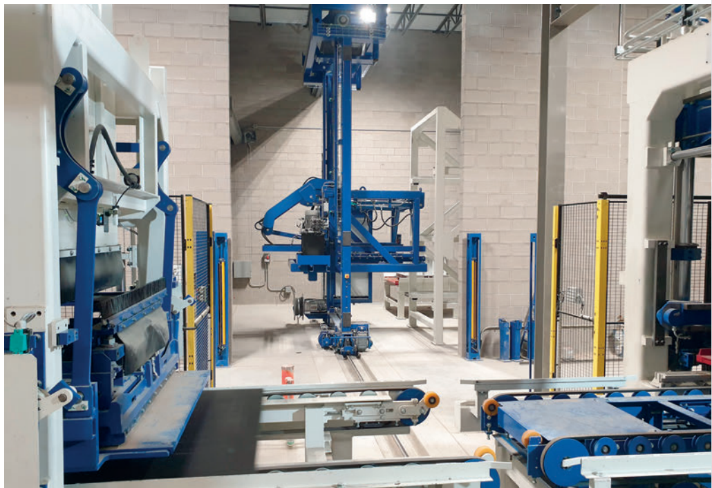
Alimentador de estantes automático, que realiza el cambio de molde
