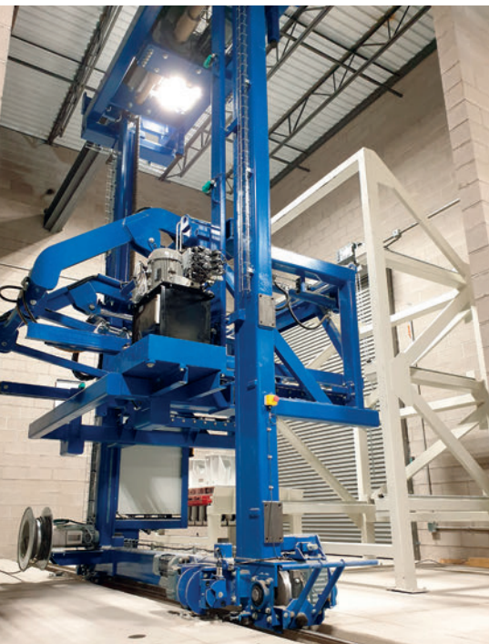
Alimentador de estantes automático, que realiza el cambio de molde
