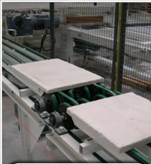
Encaminhamento automático dos produtos e dos moldes Automatic product and mold conveying system
