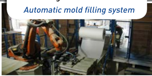
Encaminhamento automático dos produtos e dos moldes Automatic product and mold conveying system
