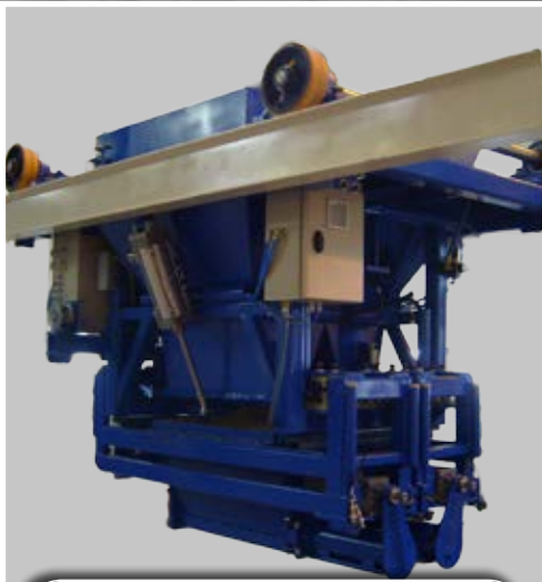
Enchimento dos moldes com dosagem automática Automatic mold filling system
