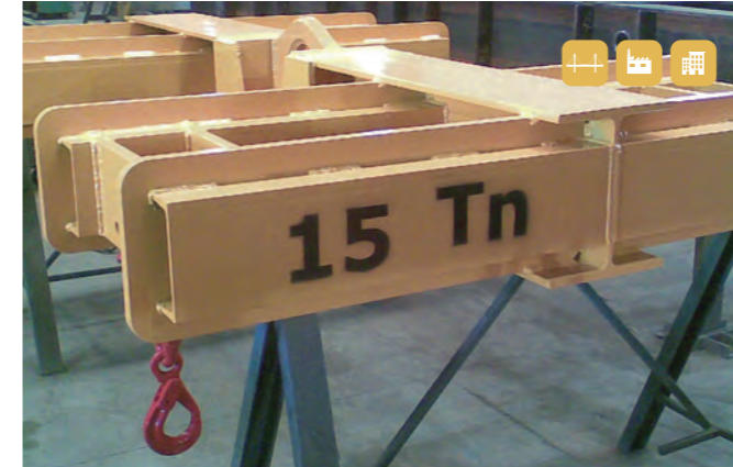
Balancín para elementos 3D
