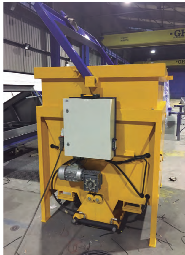
Detalle de cuba con agitador
