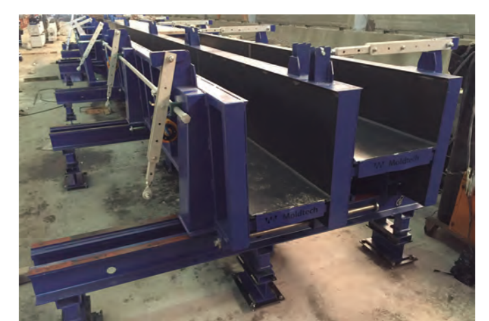
Tape de extremo preparado para conexión con viga
