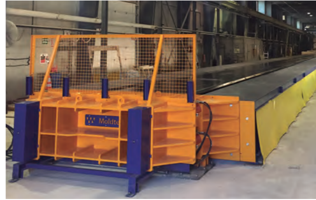
Molde autoportante de placas TT para techos y pre-losas de edificios industriales y comerciales como garajes de parking.
