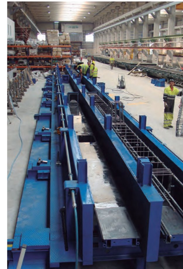
Molde de columnas doble preparado con armadura
