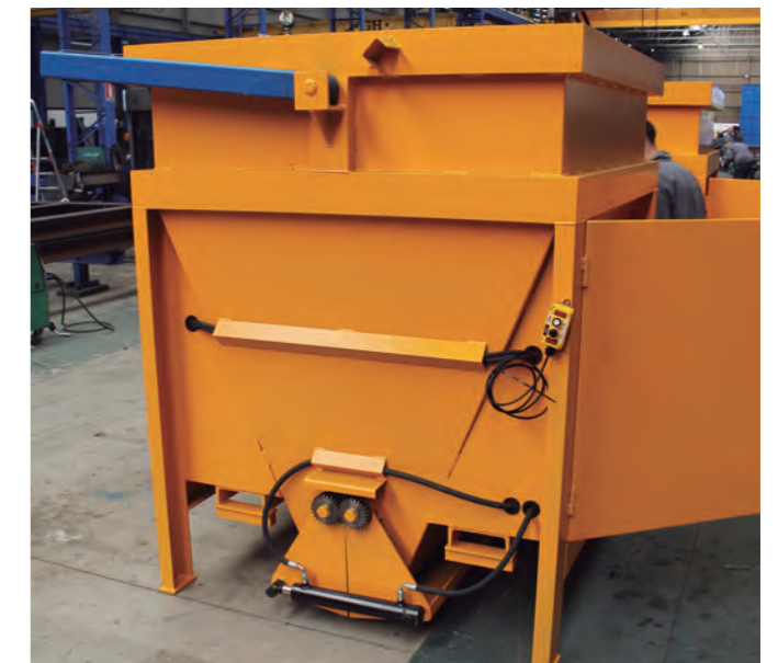
Detalle del sistema de apertura hidráulico
