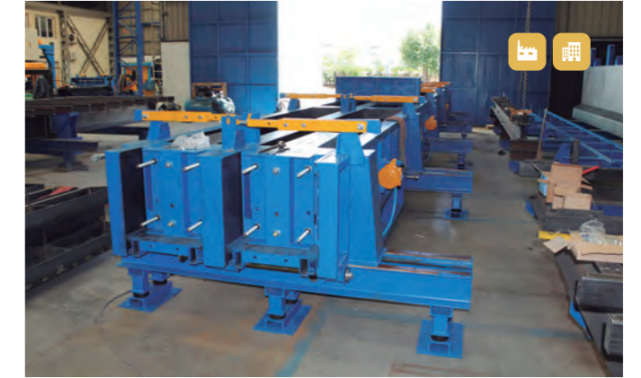
Molde de columnas doble hidráulico con tapes de extremo
