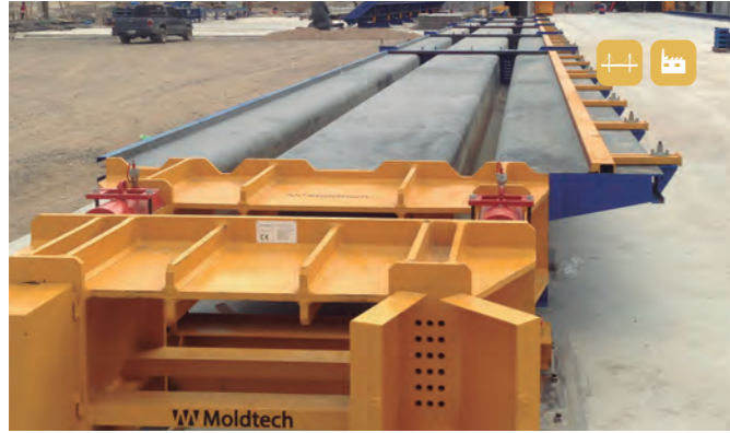
Molde autoportante de placas TT para techos y pre-losas de edificios industriales y comerciales como garajes de parking.
