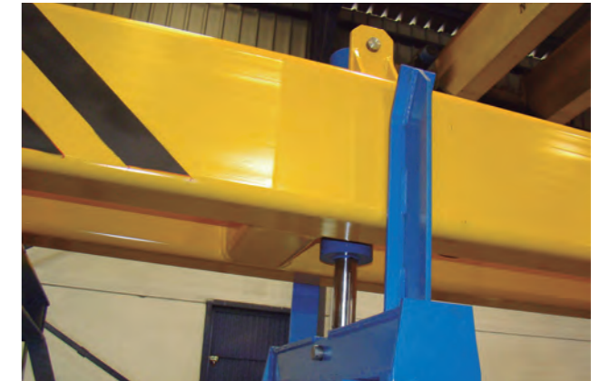
Detalle de volteador con elemento prefabricado
