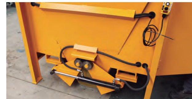
Detalle del sistema de apertura hidráulico
