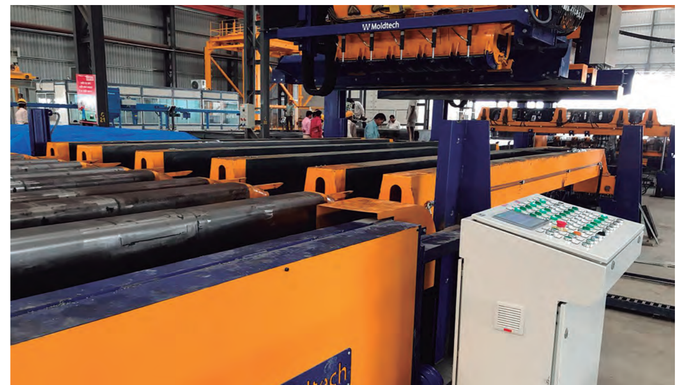
Moldes en preparación para entrar en la estación de llenado
