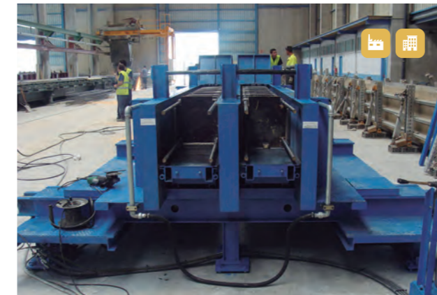
Molde de columnas doble preparado con armadura
