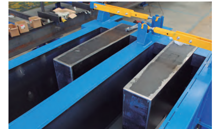
Tape de extremo preparado para conexión con viga
