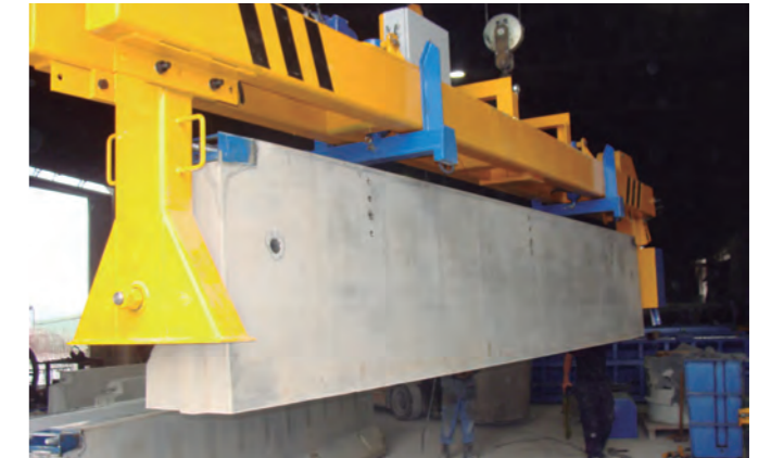
Detalle de volteador con elemento prefabricado
