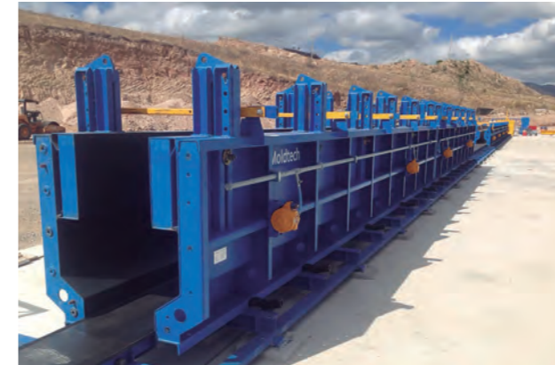
Laterales para viga TITL sobre pista universal
