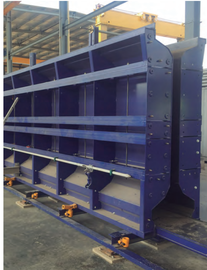
Moldes laterales para vigas de puente
