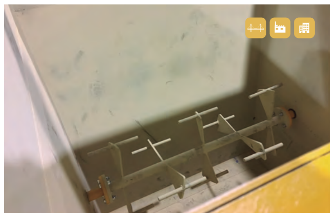
Detalle agitador en interior de cuba
