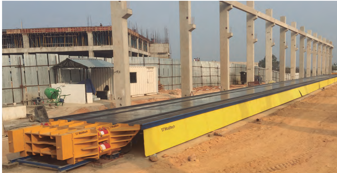
Molde autoportante de placas TT para techos y pre-losas de edificios industriales y comerciales como garajes de parking.
