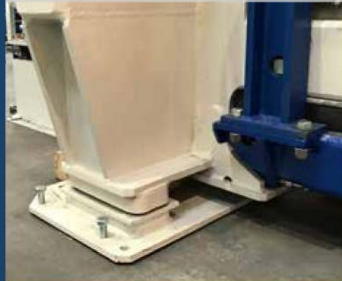
Estrutura da prensa elevada apoiada sobre uma suspensão antivibratória
