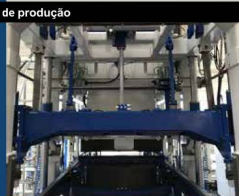
Fixação rápida do pilão
