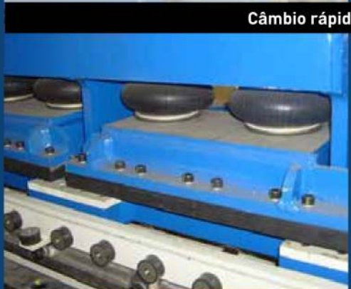
Fixação rápida dos moldes
