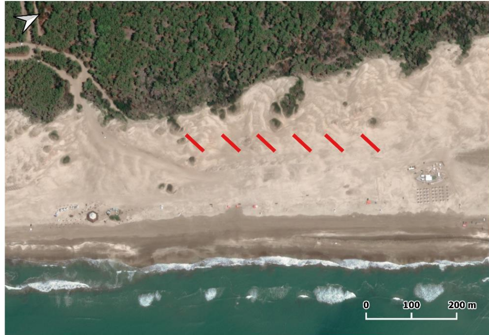
Figura 72. Ubicación y orientación recomendada de una serie de enquinchados de aproximadamente 30 m de largo en un sector de playas al norte de Pinamar. Los vallados se dispusieron en dirección normal al viento sudeste; en línea recta entre con una separación al menos igual al largo de cada estructura; y ubicados directamente por delante del pie de duna y el comienzo de la vegetación dunar.
