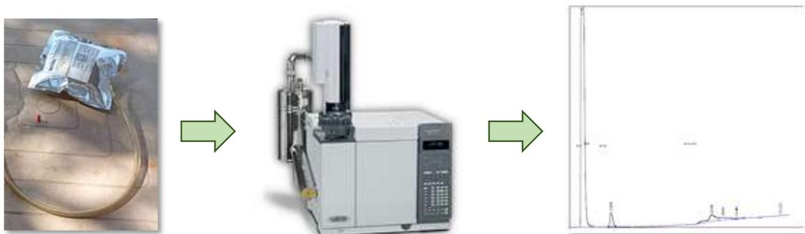
**Figura 4.** Análisis de gases de combustión mediante cromatografía de gases.
