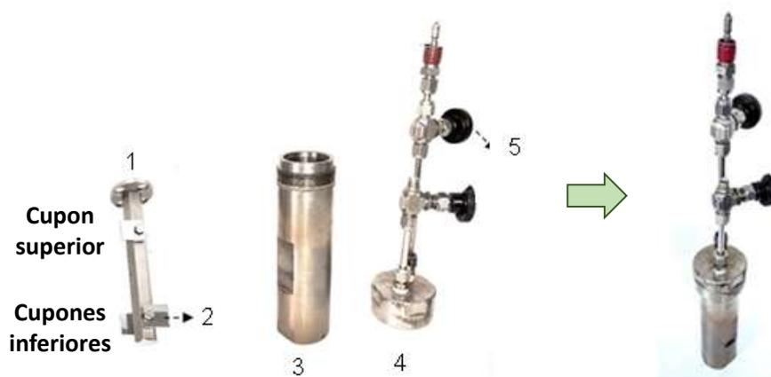
**Figura 11.** Reactor *batch* para pruebas de integridad: (1) Porta cupones, (2) cupones de hierro gris, (3) Recipiente cilíndrico, (4) Tapa con roscado interno y sello, (5) Válvulas de cierre.
