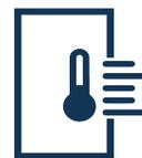
El coeficiente de transmitancia térmica, indicado con U y medido en W/(m<sup>2</sup>K), expresa la capacidad de aislamiento térmico de 1 m<sup>2</sup> de un elemento, en presencia de una diferencia de temperatura de 1°K entre el interior y el exterior.
