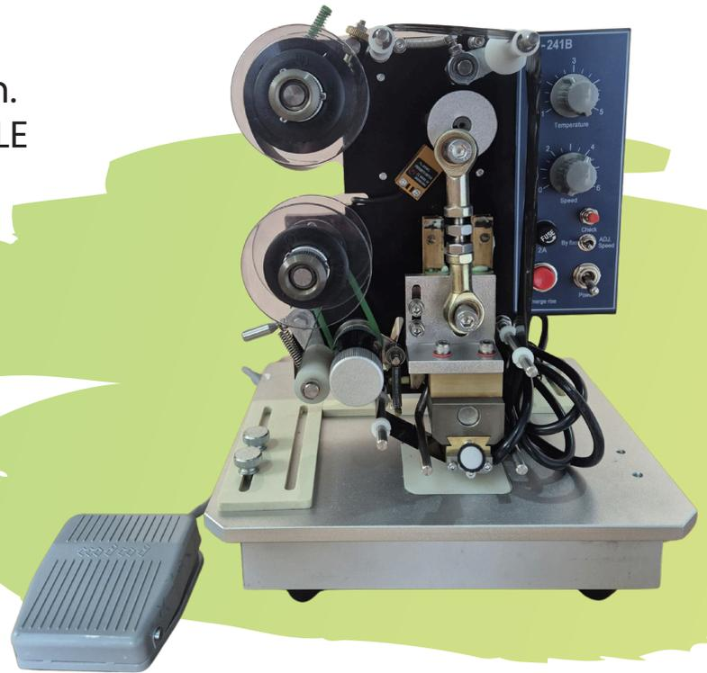
Equipos para codificar productos en forma manual. Cuenta con una gran performance en ausencia de envasadoras automáticas. NO REQUIERE AIRE COMPRIMIDO.
