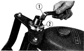
① Steering stem nut tool ② Steering stem nut Fig. 60
