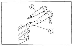
①Muffler ② Spark arrestor Fig. 101
