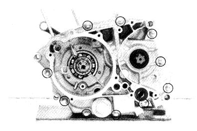
Tighten the right crankcase bolt.
