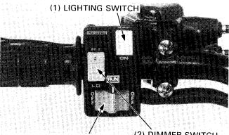
(3) ENGINE STOP SWITCH (2) DIMMER SWITCH
