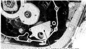
1 (1) OIL PUMP DRIVEN SPROCKET COVER
