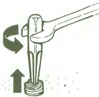
4. Remove broken stud
