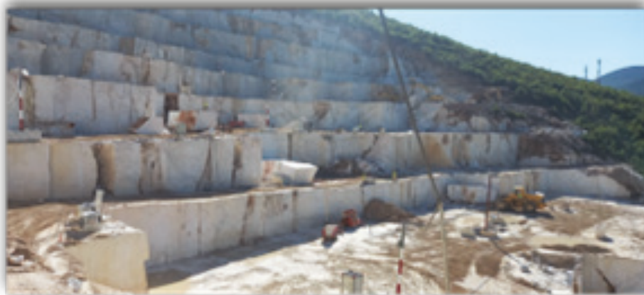
Fig. 1. Vertical benches in open-pit quarry. Şekil 1. Açık ocak ocağında dikey basamaklar.
