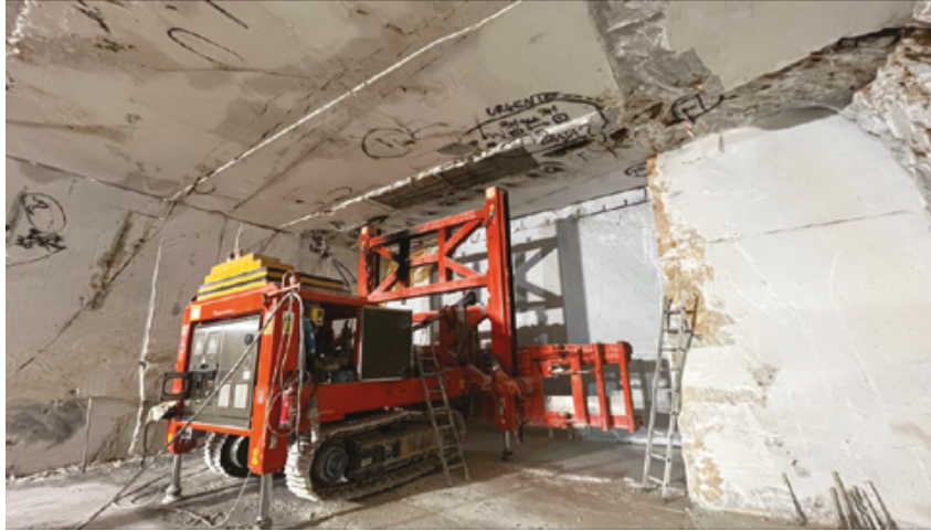
Fig. 3. Chain saw machine creating vertical and horizontal cuttings. Şekil 3. Zincirli testere makinesi ile dikey ve yatay kesimler yapımı.
