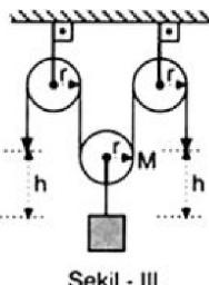
Makaralardan oluşan Şekil-I, Şekil-II, Şekil-III deki düzeneklerde iper  $h$  kadar çekildiğinde K, L, M makalarının tur sayıları sırasıyla  $n_K$ ,  $n_L$ ,  $n_M$  olmaktadır.
