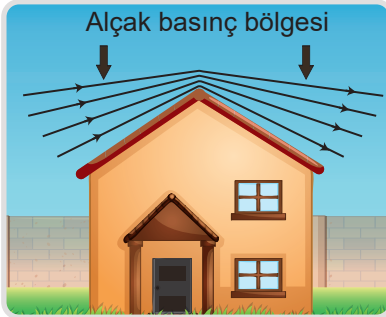
Şekil 2.31: Rüzgârın çatı üzerinde oluşturduğu alçak basınç bölgesi
