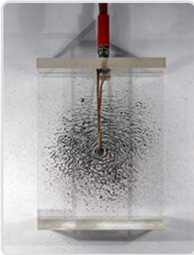
Görsel 1.16: Akım geçen iletken telin etrafında oluşan manyetik alanın demir tozlarına etkisi
