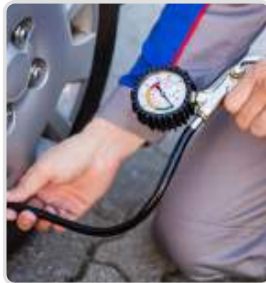
Görsel 2.17: Manometre ile tekerlekteki hava basıncının ölçülmesi
