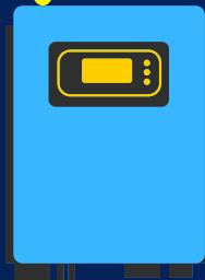
El inversor toma la energía **DC** generada por los paneles y la **convierte** en **corriente alterna (AC)**, que es la forma de electricidad utilizada por los equipos y electrodomésticos del hogar o negocio.
