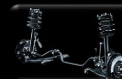
Suspensión Delantera McPherson + Barra estabilizadora
