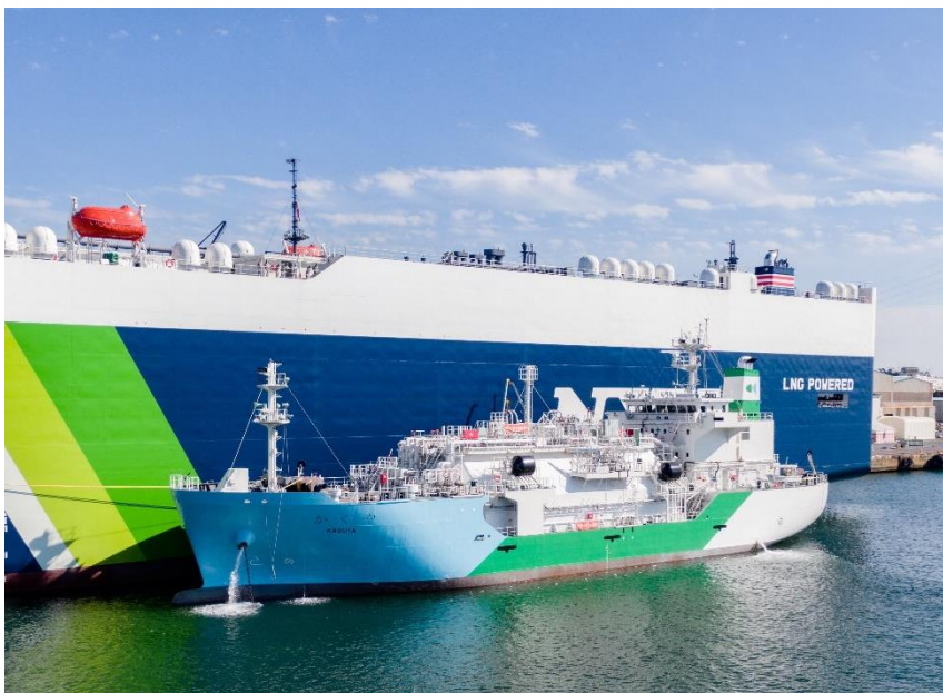
“ Kaguya ” supplying LNG fuel
