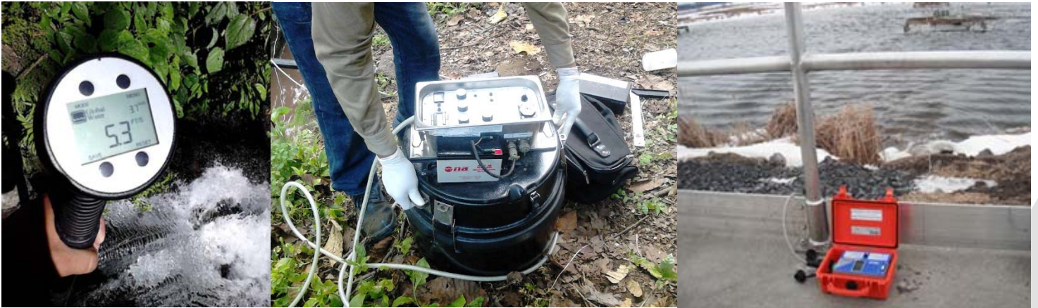
Imagen 15: De izquierda a derecha: Medidor de Caudal tipo probeta, Muestreador Automático Compuesto y Medidor de Caudal por área tipo compuesto.
