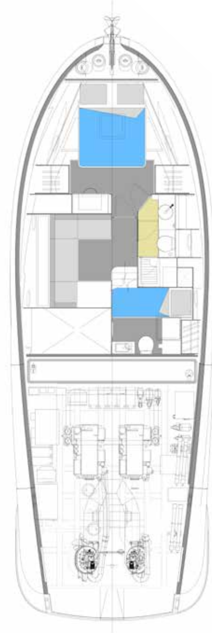
LOWER DECK with beauty corner in owner cabin, dinette with cabinet and a crew cabin including head Mit Beauty Ecke in der Eignerkabine und Sofa und Kochnische und Crewkabine mit Bad
