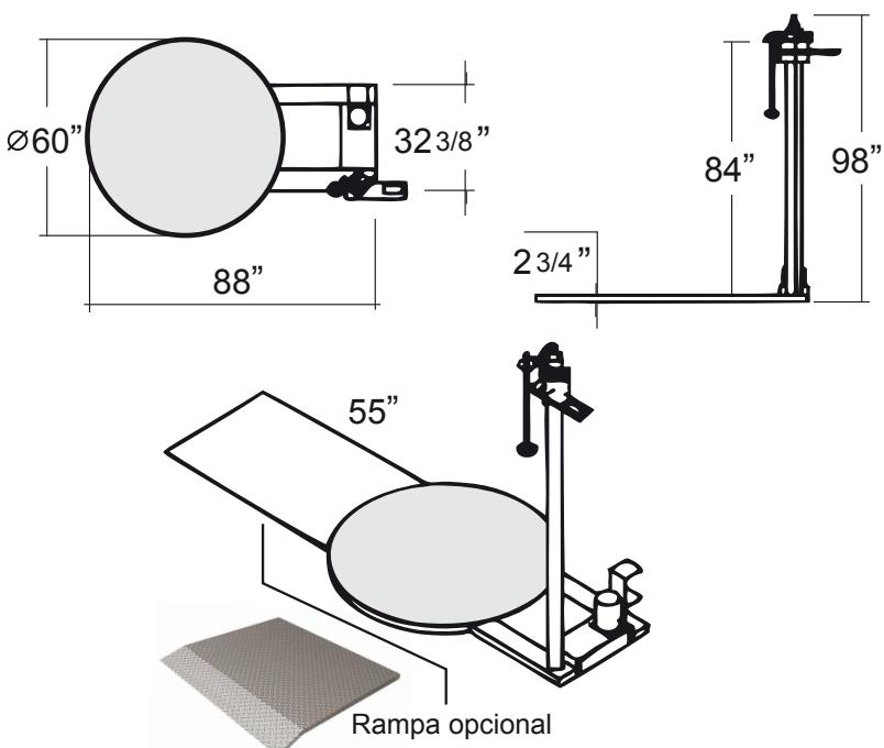
**Semi Automática de giro motorizado para empleo máximo de 60" de ancho x 114" de largo x 95" de alto**
