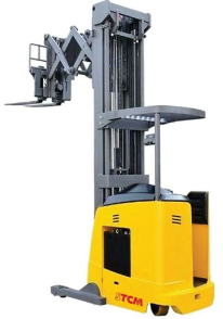
Montacargas Doble Reach Modelo: RR/RD Cap. 1600 kg Altura: 9.00 m (Elevación 1 ton.)
