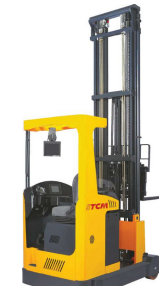
Montacargas Mástil Retráctil Modelo: RTQ Cap. 2000 kg Altura: 3.00/12.00 m
