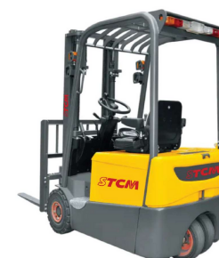
Montacargas 3 Ruedas Modelo: SC Cap. 1600/2000 kg Altura: 3.00/6.20 m
