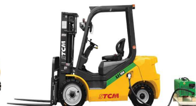
Montacargas de Litio Modelo: FEL Cap. 2000/3500 kg Altura: 3.00 m
