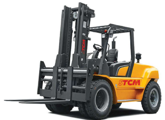
Montacargas 4 Ruedas Modelo: FD Cap. 8-10 ton Diesel Altura: 2.00/6.00 m
