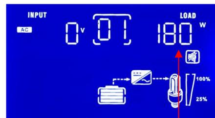
Carga conectada en Watts
