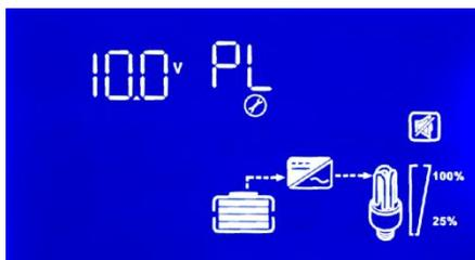
**PL:** Configuración de apagado por bajo voltaje de la batería:
