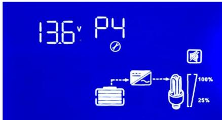
**P4:** Configuración de carga flotante de voltaje de la batería:
