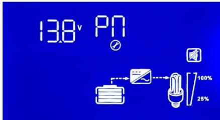
**PN:** Voltaje de la batería para reiniciar el inversor en modo DC
