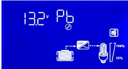
**PB:** Configuración de voltaje más alto en el modo Prioridad batería en el modo de prioridad de batería, el voltaje de la batería se restaura y el inversor cambia de energía de ciudad a modo de inversión.
