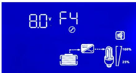
**F4:** El voltaje más bajo de la batería en Modo desatendido para apagar la MCU del inversor.
