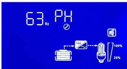
**PH:** Ajuste de frecuencia máxima de entrada de CA:
