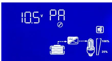
**PA:** Configuración de voltaje más bajo en el modo Prioridad batería:
