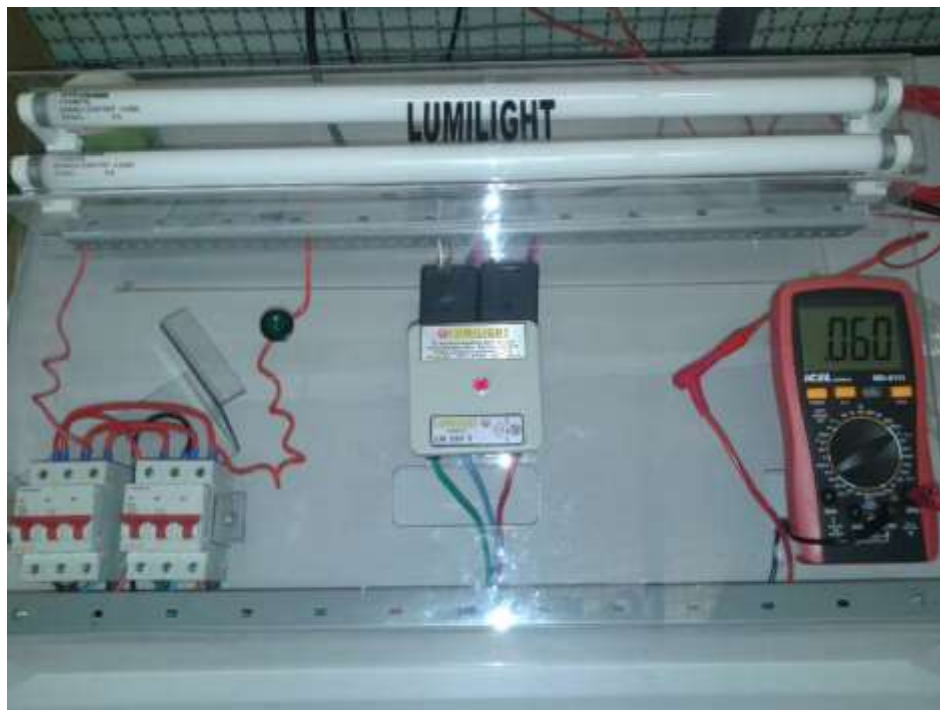
Figura 4 – Arranjo experimental ilustrando a presença de 60Hz na rede após a ação do filtro.
