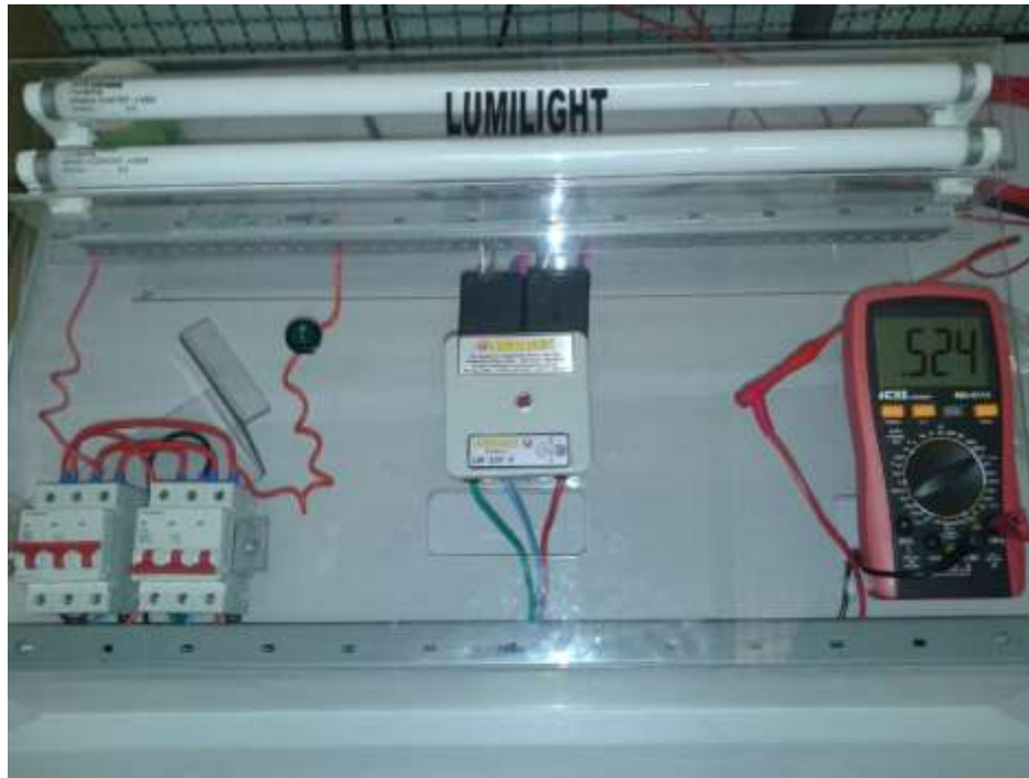
Figura 3 – Arranjo experimental ilustrando a presença de ruído na rede sem a ação do filtro
