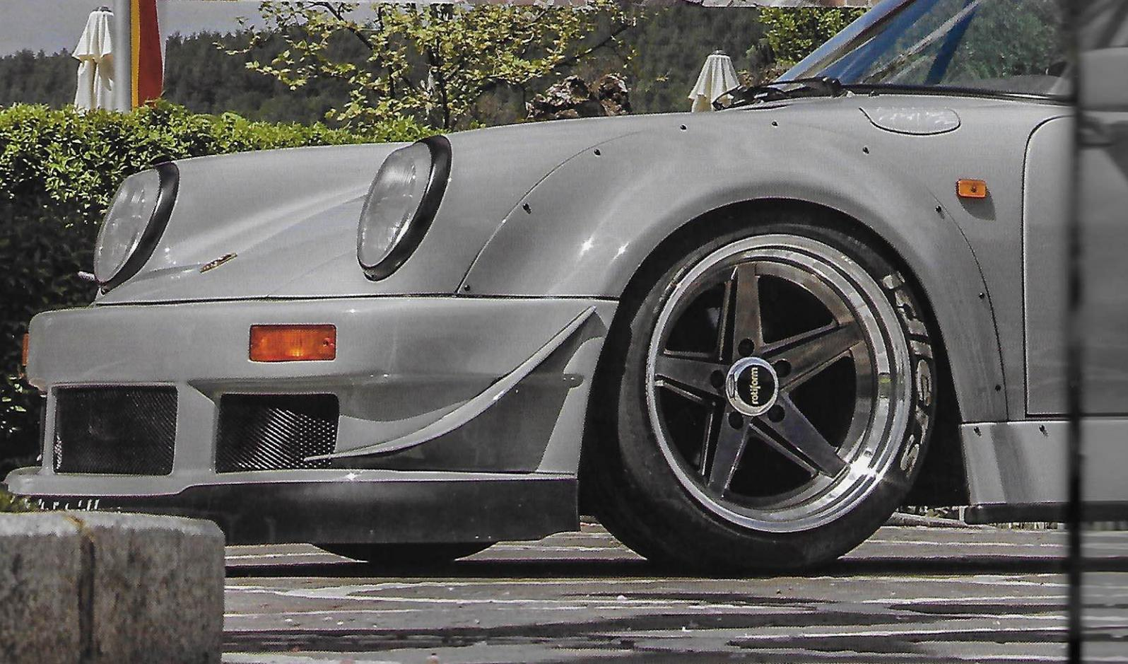
Um den massiven Zuwachs von Spur und Rad-Reifen-Kombi zu generieren, mussten die originalen Kotflügel aufgeschnitten werden.
