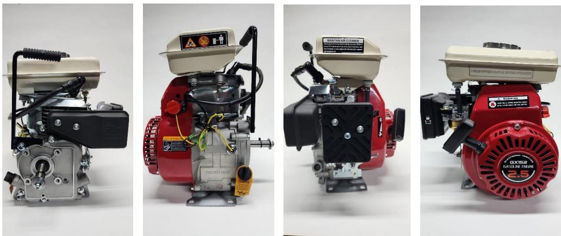
**1.9 Sellado del motor:** Los motores deberán tener sellado la tapa de la bobina, tapa de cárter, mufla y cabezote.
