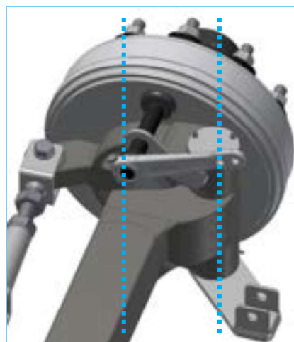
Figura 2. Eje de giro adelantado respecto al punto de apoyo
