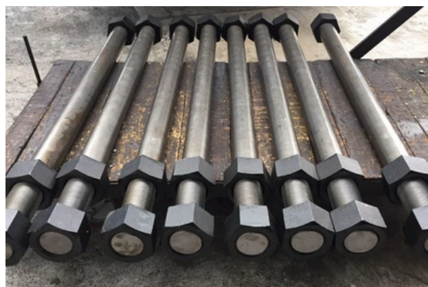
Anclas de cimentación
