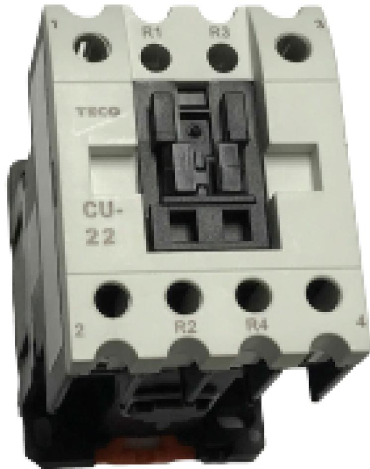
El contactor es el aparato de maniobras más utilizado en la industria y en las instalaciones eléctricas de edificios, ya sean éstos públicos o privados. Es un aparato de maniobras que permite el arranque en directo de motores asincrónicos trifásicos, soportando una corriente de arranque varias veces mayor que la asignada (7,2 veces mayor según normas IEC 60947).
