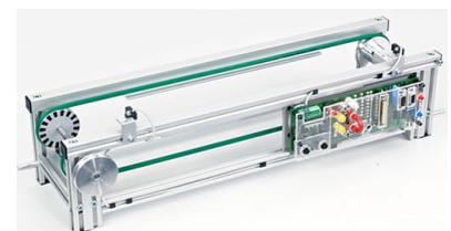
y está preparada para la conexión a un control lógico programable. Se puede combinar con otras cintas transportadoras, curvas o nodos de distribución. Las estaciones IMS se pueden conectar directamente a la cinta y controlar conjuntamente por medio del PROFIBUS.
