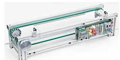
con piezas de trabajo, es el vínculo entre los subsistemas individuales y está preparada para la conexión a un control lógico programable. Se puede combinar con otras cintas transportadoras, curvas o nodos de distribución. Las estaciones IMS se pueden conectar directamente a la cinta y controlar conjuntamente por medio del PROFIBUS.
