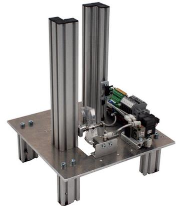
Para la seguridad en el funcionamiento y la prolongación de la vida útil de los elementos neumáticos y las unidades de control, se requiere un juego de mantenimiento compuesto de: filtro, válvula de regulación de presión con indicación del nivel de presión y engrasado.
