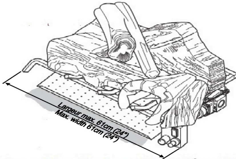
Assemblage Typique - Bûche Décorative au Gaz (Gaz Naturel ou Propane) - Typical Assembly of a Gas Fire Log Set (Natural or Propane Gas)
