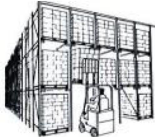
*Drive In – Drive Thru: Sistema de almacenamiento de gran densidad que incrementa el número de estibas por unidad de área. Se puede trabajar el sistema mediante robot transportador o unos rieles guía en piso para que el montacarga penetre el túnel.*
