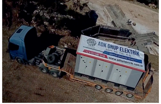
Dimaks 3.83MVA Trafo Tesisleri
