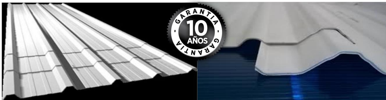
La **TEJA UPVC TERMOACÚSTICA** está conformada por tres capas en polímeros de alta ingeniería, distribuidas en una capa superior externa de UPVC con un aditivo para contrarrestar los rayos ultravioleta, una capa intermedia a nivel de núcleo con espuma en PVC y por último la capa externa inferior en UPVC reforzado.
