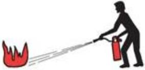
3. SQUEEZE HANDLES TOGETHER AND SWEEP THE EXTINGUISHER STREAM SIDE TO SIDE
