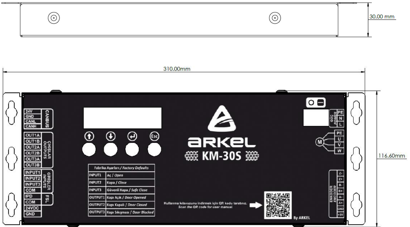
Şekil 13 KM-30S Uzunluk x Genişlik x Yükseklik Ölçüleri
