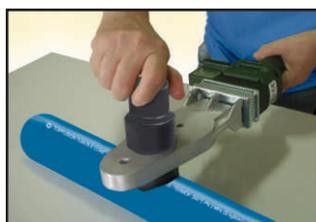
**03** Com os bocais apropriados para a operação, colocar a termofusora sobre perfuração do tubo por um tempo de 15 segundos;
