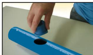
**05** Retirar a termofusora e aplicar a derivação no tubo;
