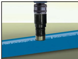
**01** Faça a furação do tubo da linha principal (50 e 90 mm) com uma serra de diâmetro 32 mm (1" 1/4);
