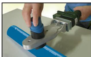
**04** Após o aquecimento do tubo, inserir a derivação no outro bocal e aquecer por 20 segundos. Sem retirar a termofusora do tubo. Tempos de aquecimento total: tubo = 35 segundos derivação = 20 segundos;
