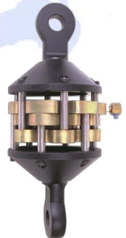
Cada sistema de torsión Tong consta de una celda de carga de tensión que convierte la tracción de la línea en una señal de presión hidráulica, que envía a un manómetro sensor de presión a través de un Manguera hidráulica de interconexión. Cada sistema también incluye herrajes de montaje.
