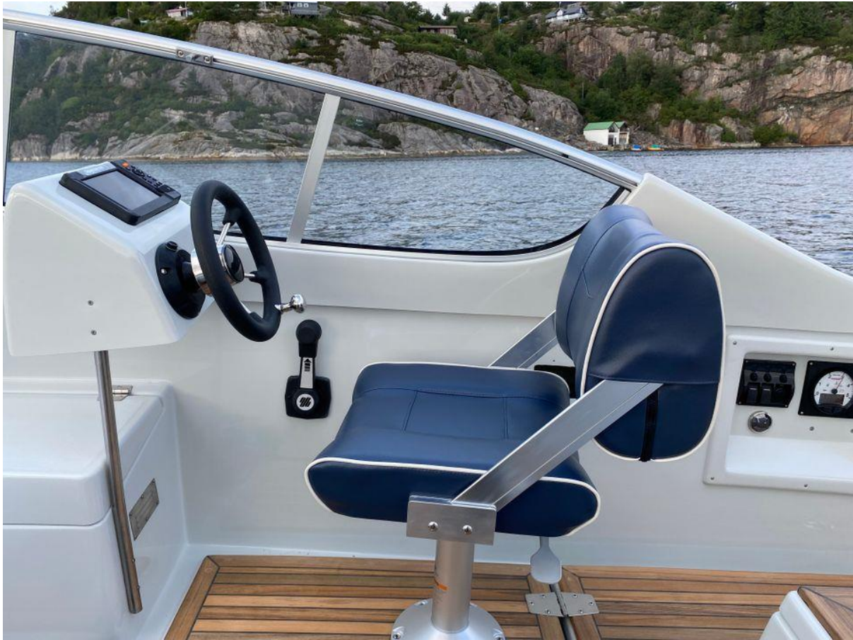
Extra främre styrplats med hydraulisk styrning, gasreglage och förarstol.
