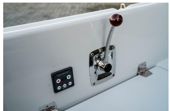
Styrning av bogpropeller vid gasreglage
