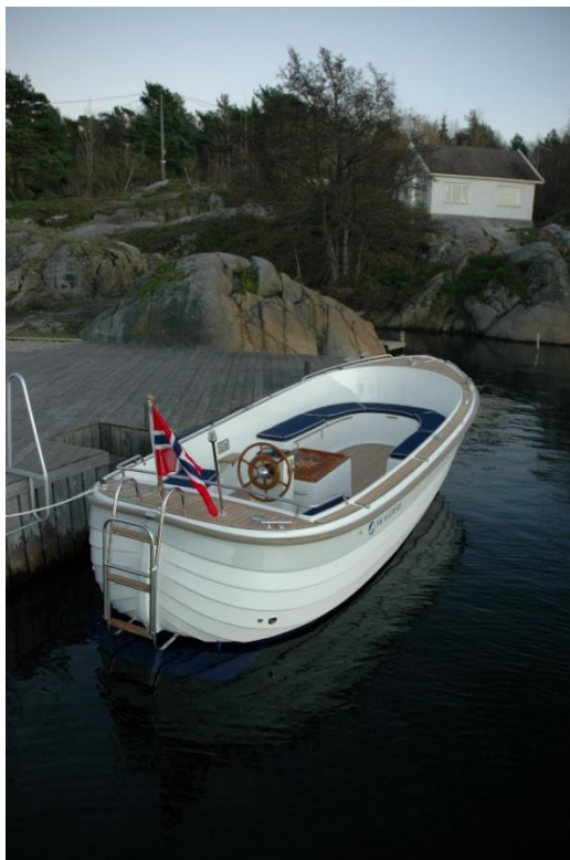
Bakre styrplats med hydraulisk styrning och ratt.
