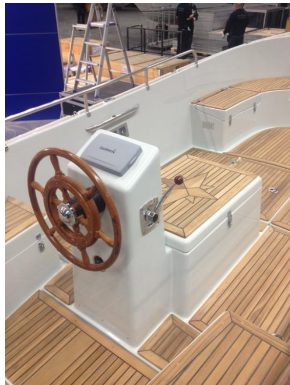
Extra främre styrplats med hydraulisk styrning, gasreglage och förarstol.
