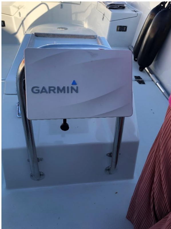
Plotterfäste i rostfritt stål monterat på motorlucka
