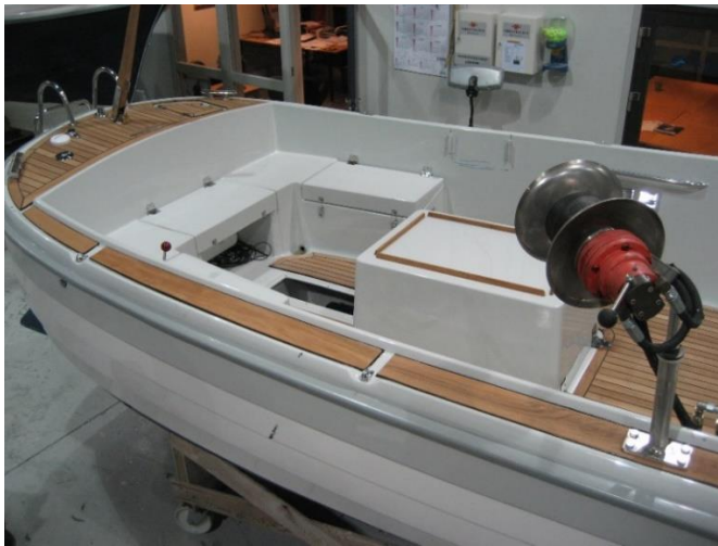
Hydralisk lindragare (finns även elektrisk av fabrikat Northlift). Dränerad fisksump med pump.
