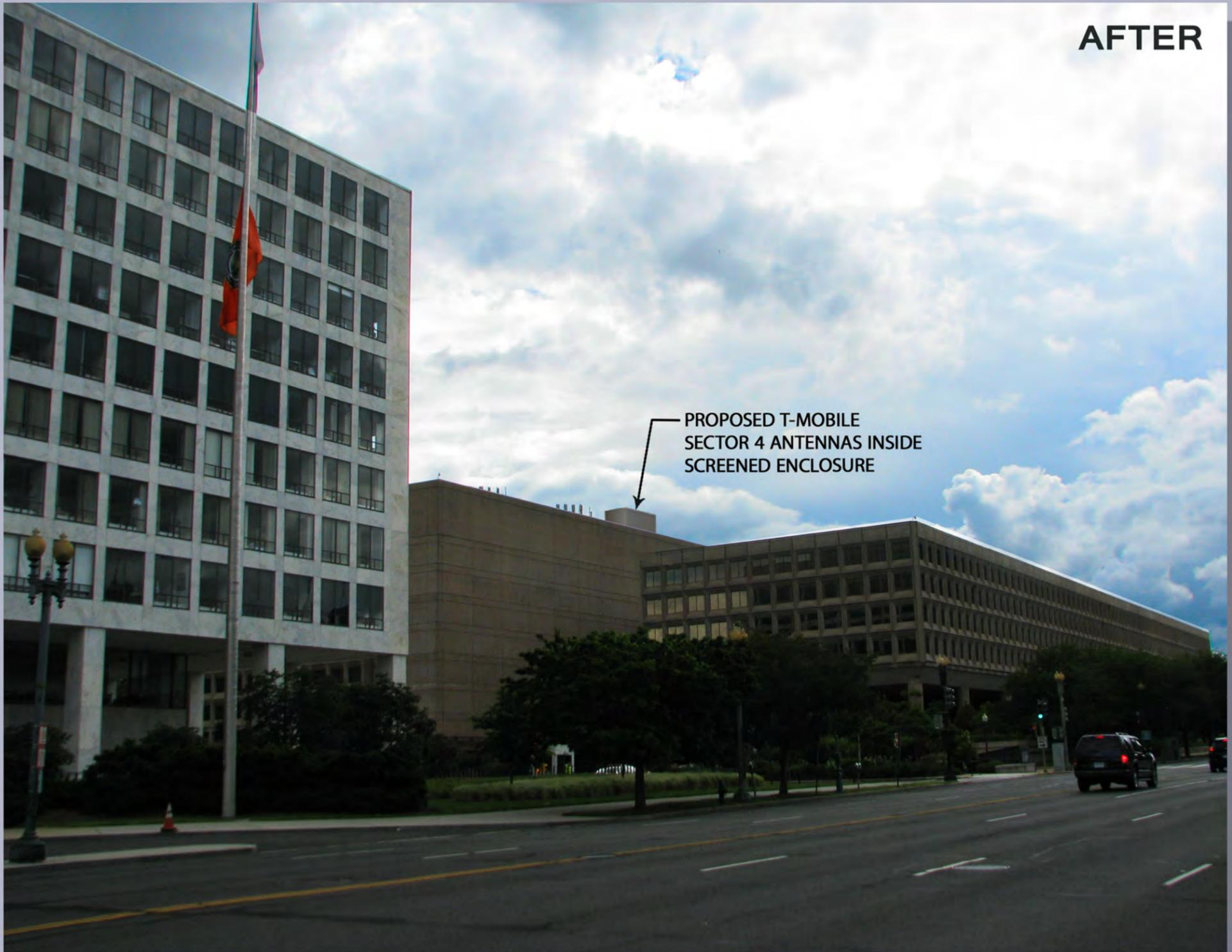
PROPOSED T-MOBILE SECTOR 4 ANTENNAS INSIDE SCREENED ENCLOSURE
